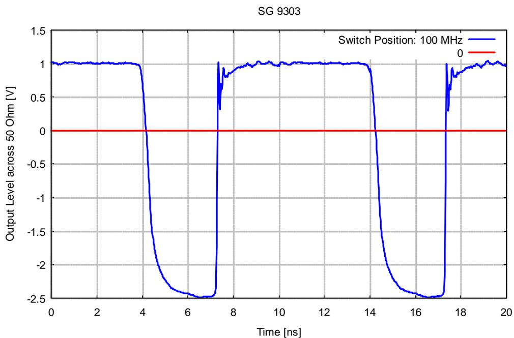
Signalverlauf am Ausgang bei 100 MHz Pulsfrequenz (im Zeitbereich)
