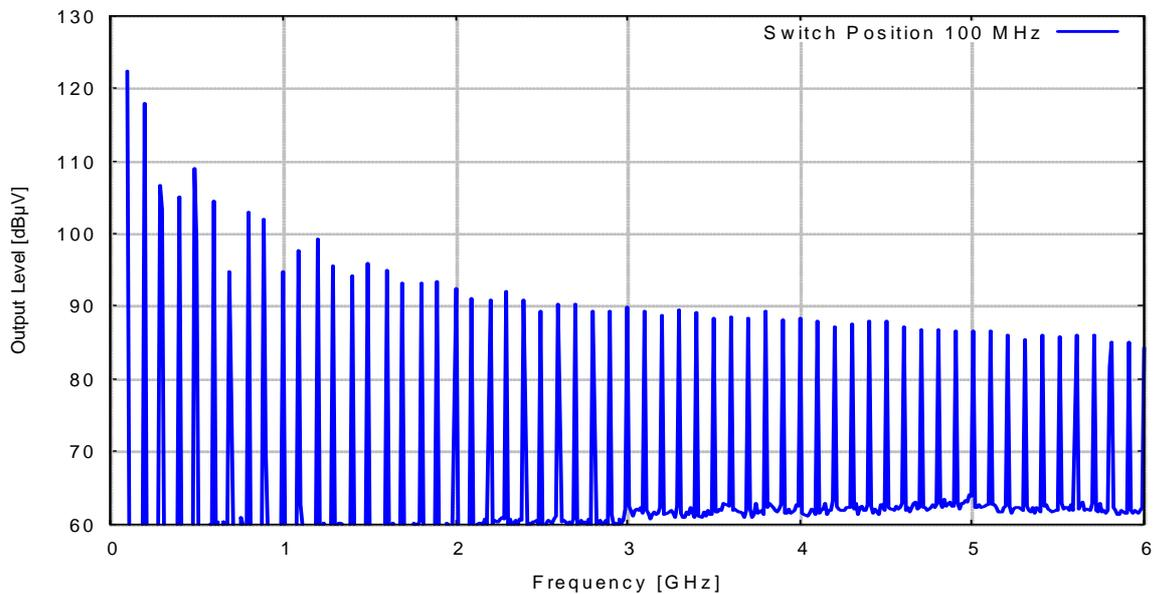
Ausgangssignal bei einer Pulsfrequenz von 100 MHz (im Frequenzbereich)
