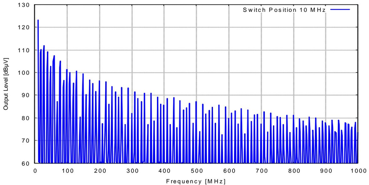
Ausgangssignal bei einer Pulsfrequenz von 10 MHz (im Frequenzbereich)
