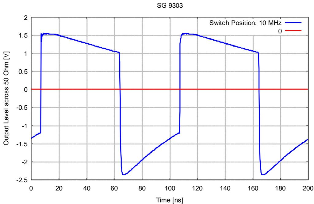
Signalverlauf am Ausgang bei 10 MHz Pulsfrequenz (im Zeitbereich)
